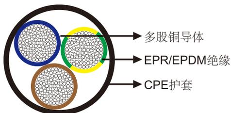
导体：IEC/EN 60228标准class 5柔软退火裸铜导体。
